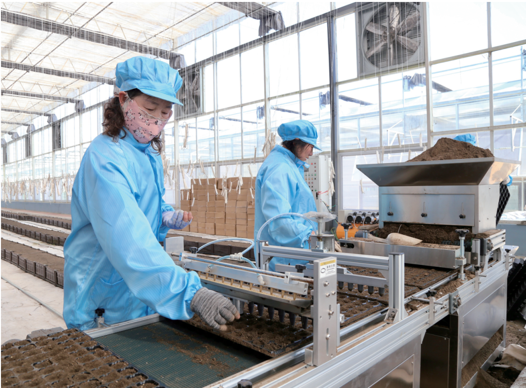
连日来，在西和县何坝镇玻璃温室大棚内，全自动穴盘育苗点种机开足马力培育辣椒苗，工人进行装基质、压盘、撒种、覆盘、放盘等工序，“机械+人工”同步作业，有效提高了工作效率。
