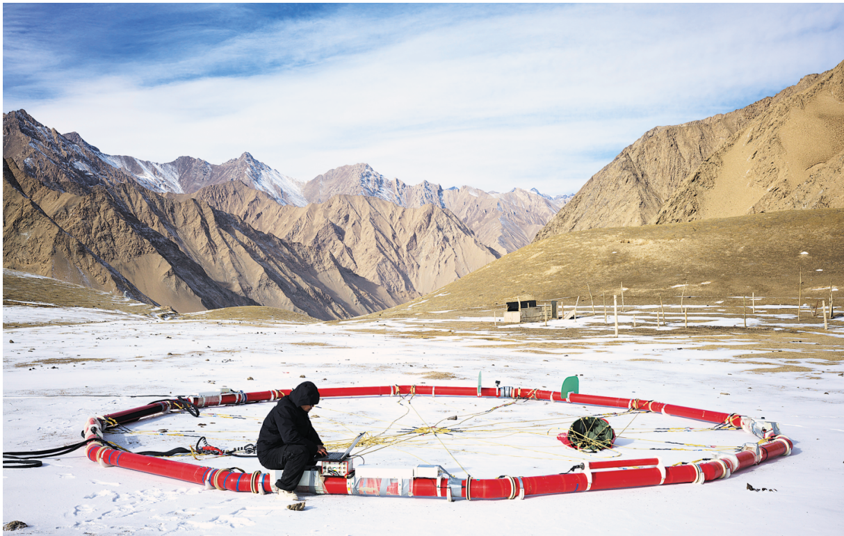
2025年1月11日,科研人员在新疆和田地区测试航空大地电磁探测系统。
