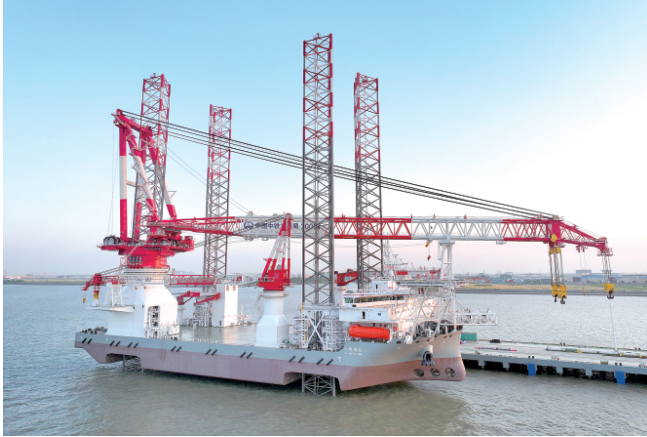
5月18日拍摄的“大桥海风”号（无人机照片）。当日，由中铁大桥局和招商工业共同研制的最新一代2000吨自升式海上风电安装平台“大桥海风”号在江苏南通交付。“大桥海风”船长138米，船宽53米，拥有4根131米高的桩腿，多项性能指标达到国际领先水平。新华社发（许丛军 摄）
