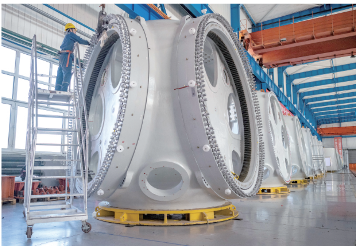
4月28日，在位于黑龙江省齐齐哈尔市的中国一重集团有限公司，工作人员在风电设备装配车间内加工风电轮毂。
