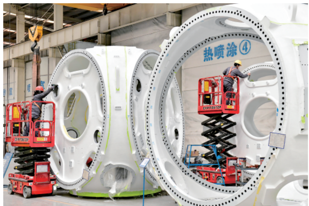
在位于山东省滨州市惠民县的山东国创精密机械有限公司，工作人员对风电轮毂进行喷涂作业（2024年1月26日摄）。 国家统计局18日发布的数据显示，今年前2个月，生产需求稳中有升，就业物价总体稳定，发展质量不断改善，经济运行延续回升向好态势，起步平稳。
