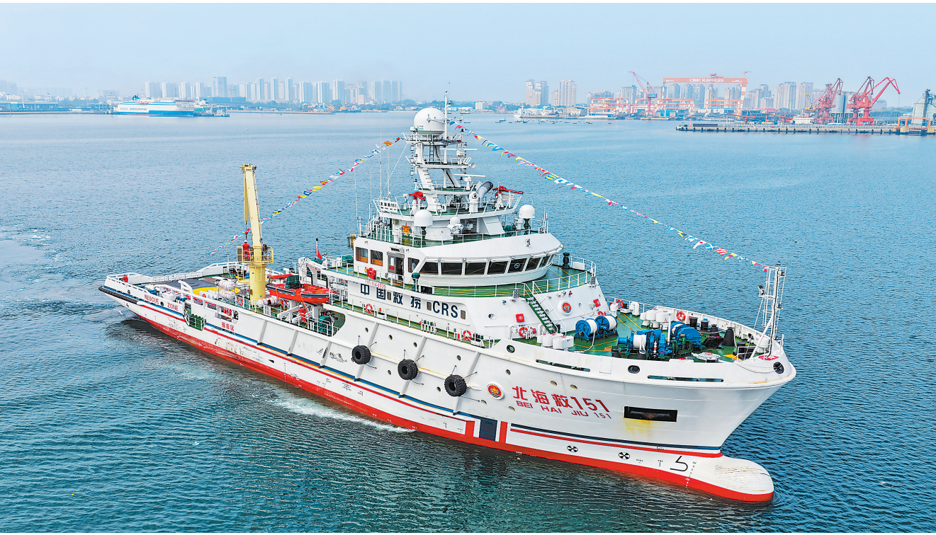
9月21日，我国自行设计建造的4000千瓦中型海洋救助船“北海救151”轮正式入列交通运输部北海救助局，为海上人命救助与海上应急保障提供更为坚实有力的支撑。这是“北海救151”轮由船厂驶抵山东烟台救助基地。 新华社发
