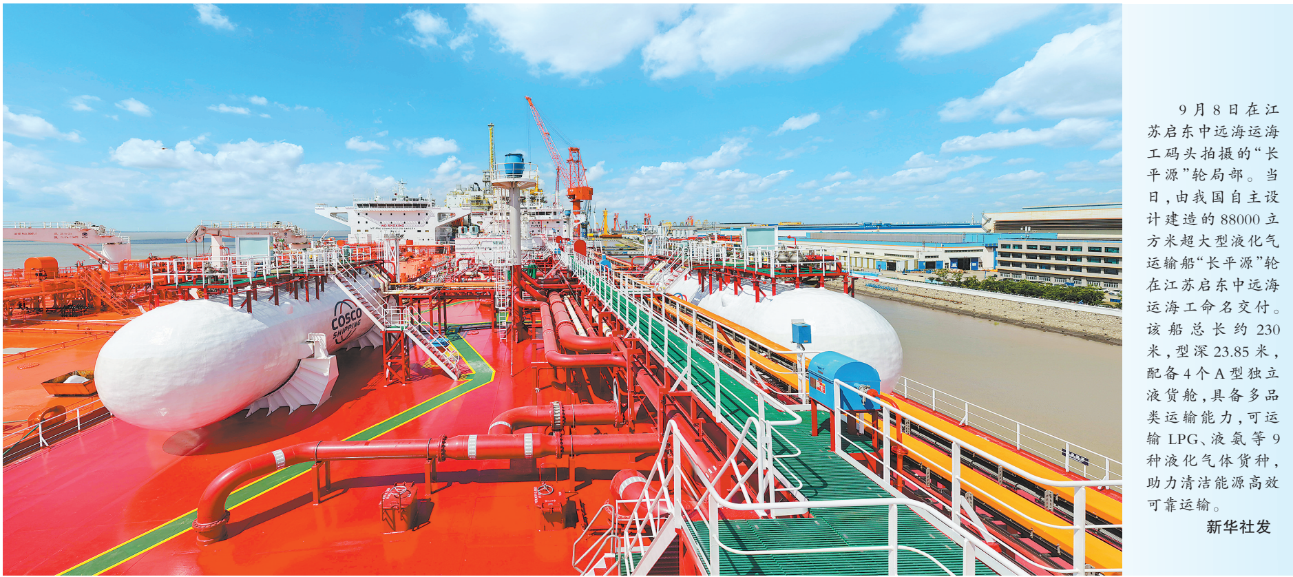
9月8日在江苏启东中远海运海工码头拍摄的“长平源”轮局部。当日,由我国自主设计建造的88000立方米超大型液化气运输船“长平源”轮在江苏启东中远海运工命名交付。该船总长约230米,型深23.85米,配备4个A型独立液货舱,具备多品类运输能力,可运输LPG、液氨等9种液化气体货种,助力清洁能源高效可靠运输。 新华社发
