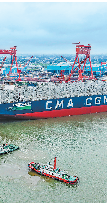
近日，在江苏扬子鑫福造船有限公司，拖轮协助建造编号为X1550的24000标箱超大型双燃料集装箱船开展出坞作业。9月2日至3日，由江苏扬子江船业集团建造的X1549、X1550两艘24000标箱超大型双燃料集装箱船相继完成出坞靠泊作业。两船是为法国达飞海运集团定制建造。船舶总长399.9米，型宽61.3米，型深33.5米，是全球先进的绿色集装箱船。
