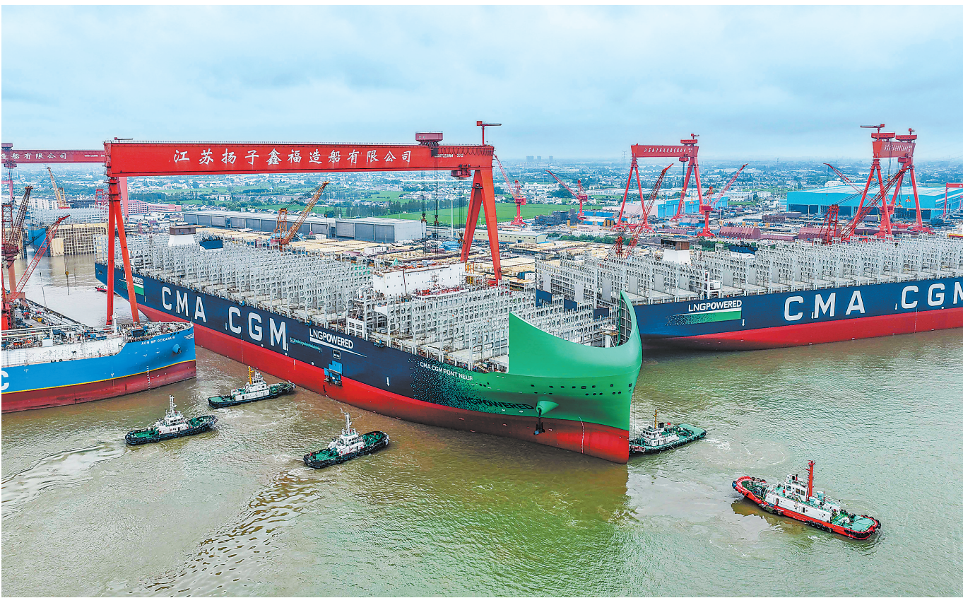
近日，在江苏扬子鑫福造船有限公司，拖轮协助建造编号为X1550的24000标箱超大型双燃料集装箱船开展出坞作业。9月2日至3日，由江苏扬子江船业集团建造的X1549、X1550两艘24000标箱超大型双燃料集装箱船相继完成出坞靠泊作业。两船是为法国达飞海运集团定制建造。船舶总长399.9米，型宽61.3米，型深33.5米，是全球先进的绿色集装箱船。
