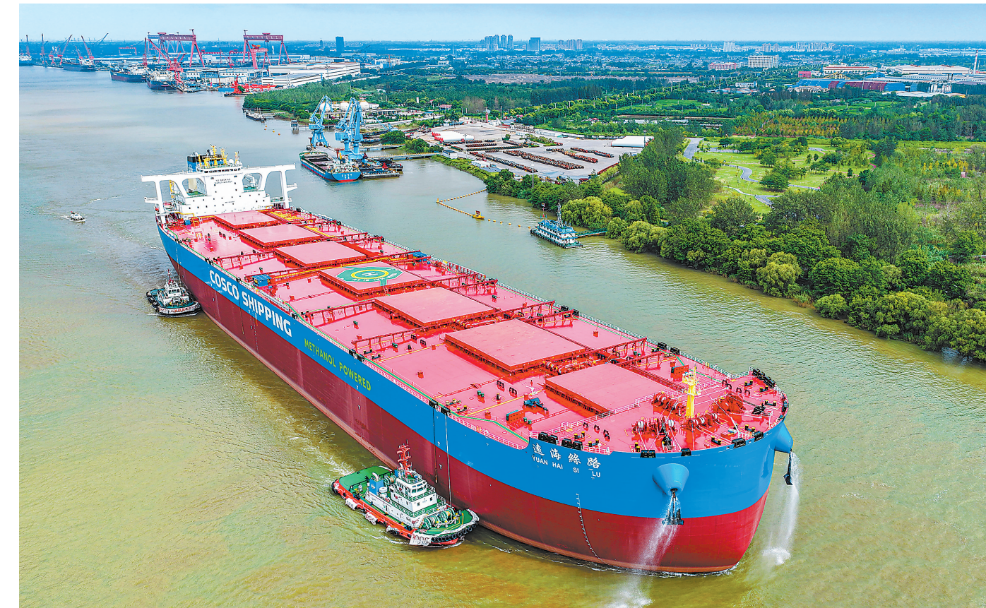
9月3日，出江试航的32.5万载重吨甲醇双燃料矿砂船“远海丝路”轮经过江苏省扬州市三江营水域。“远海丝路”轮由中远海运重工与上海船舶研究设计院联合设计，船长339.9米，型宽62米，型深30米，可满足大宗物资的远洋运输需求。
