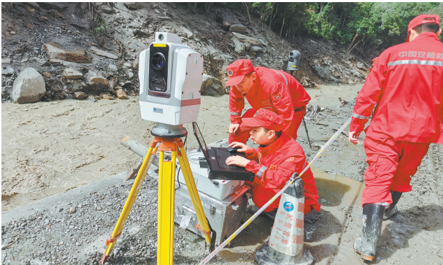
8月30日,中国安能专业救援人员利用激光AI监测仪,对现场滑坡、落石等风险开展动态监测。
