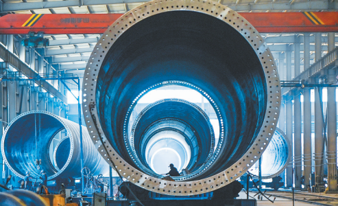
甘肃创腾电力装备有限责任公司工人在风电塔筒生产线上忙碌。
