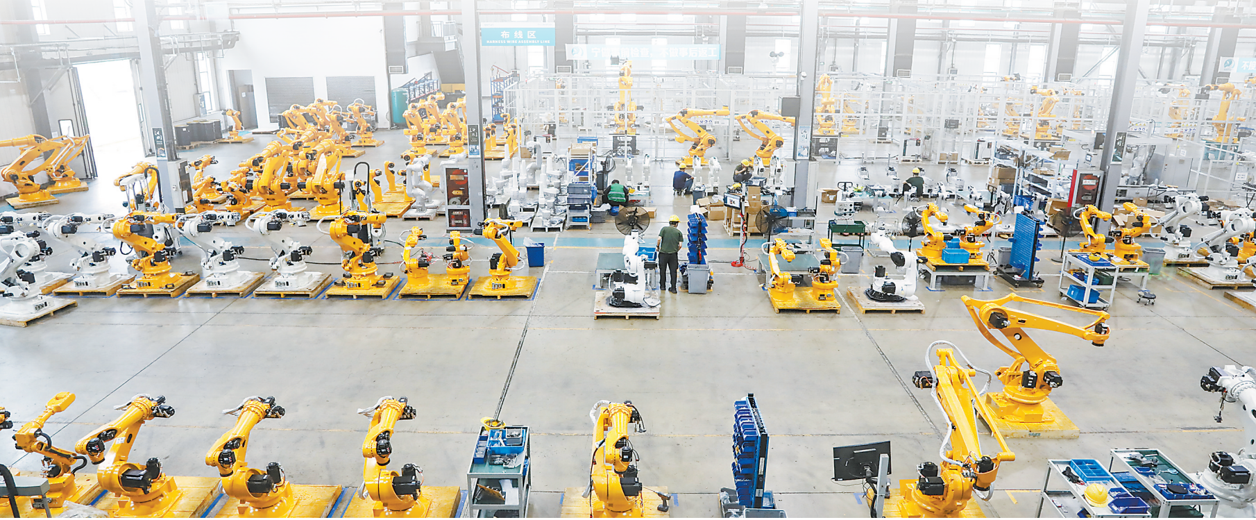
工作人员在位于南京的埃斯顿自动化股份有限公司车间里调试工业机器人。
