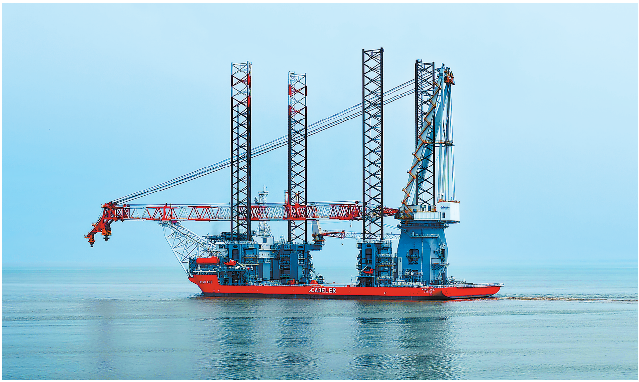
7月21日,NG20000型风电安装船“峰盛”号在江苏启东正式交付启航。该船拥有超过5600平方米超大甲板、17600吨有效载荷、大于3300吨主吊起重能力,可精准安装20兆瓦级以上超大型风机。
