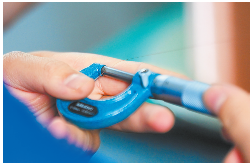
用千分尺测量超微细电磁线。
