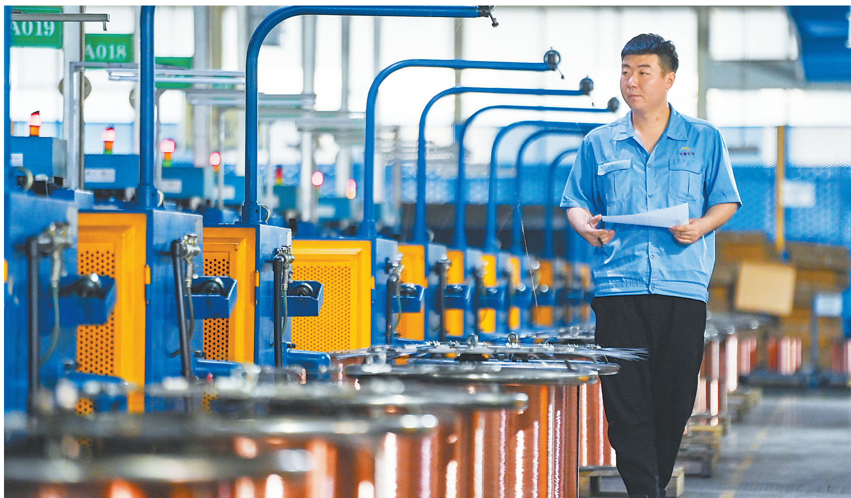
查看微细电磁线生产线。
