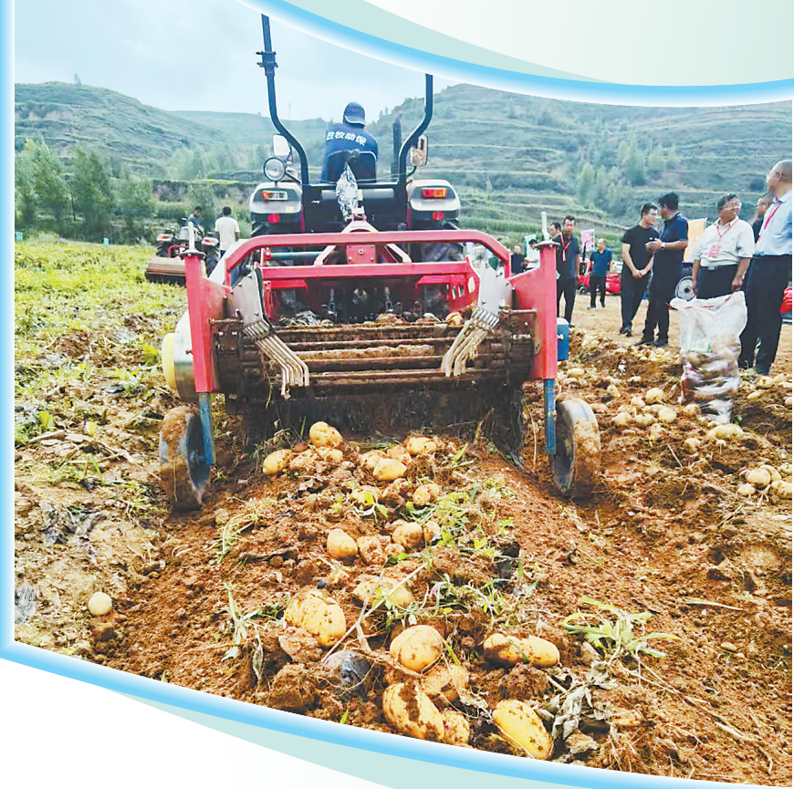
△马铃薯收获机在不伤根茎的情况下大幅提升效率。
