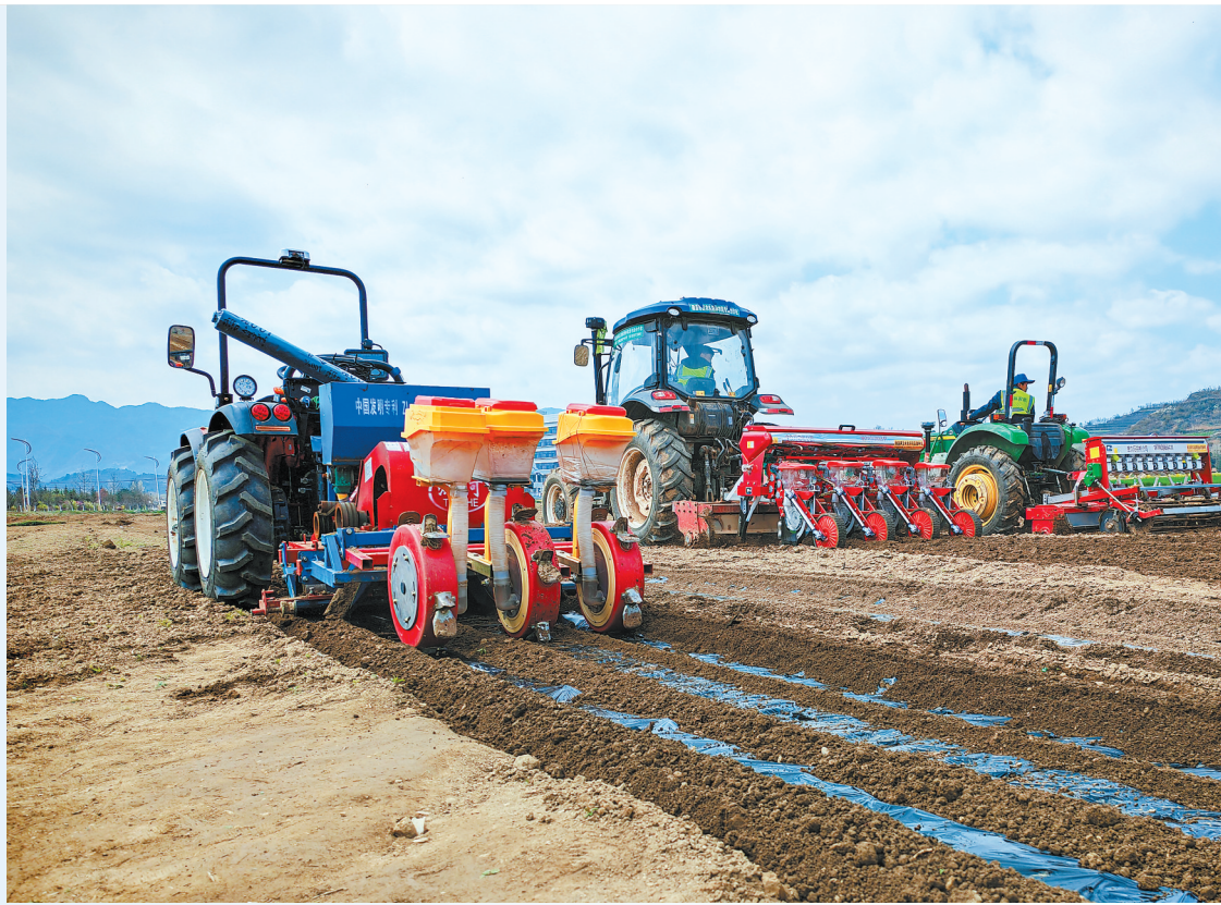
△高标准农田里无人驾驶农机实现覆膜、起垄、点种一体化。 本文图片均由新甘肃·甘肃日报记者马国顺摄
