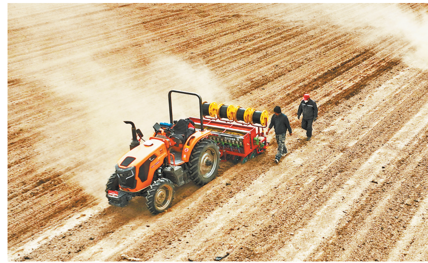
高台县巷道镇殷家桥村绿色高产小麦种植基地,农户使用北斗导航自动驾驶拖拉机牵引的播种、施肥、滴灌带铺设一体机,进行春小麦播种。 新甘肃·甘肃日报通讯员 王将
