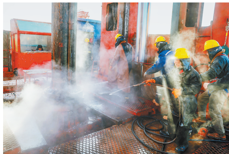
张掖青阳煤矿项目施工现场,工人为钻机降温。
