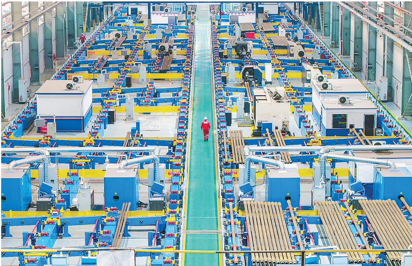
智能化检修保障海上油气生产——位于天津市滨海新区的中海油服钻井事业部钻具检修自动化车间可实现从钻具清洗、检测、修理到喷涂标识的全流程自动化作业,为海上油气高效勘探开发提供有力支撑。
