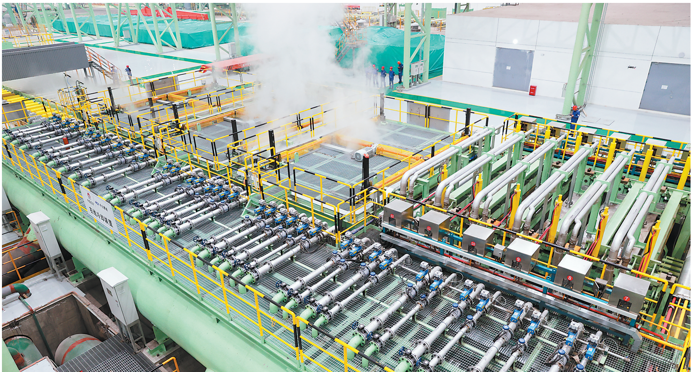
酒钢集团炼轧厂4200毫米宽厚板生产线冷却流程。
