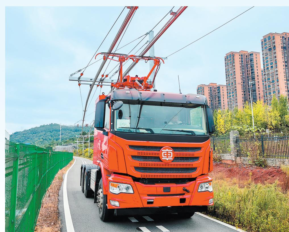
这是我国研发的体型硕大、头顶有“辫子”(受电弓)的重型卡车“辫子重卡”,它运行使用清洁电力,车辆受电弓在线取电,续航不受电池容量限制,此外还拥有风力发电和光伏发电“绿电直连”、多台重卡“串联列队”行驶、智能驾驶等“黑科技”,适合在风力发电、光伏发电富集地区用于公路、矿山重载货物运输,对促进物流绿色转型发展具有积极意义。
