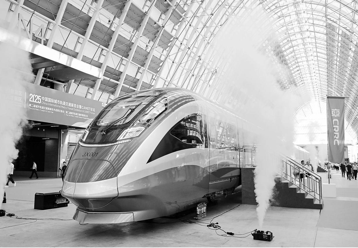
9月18日，由中国中车自主研制且拥有完全自主知识产权的首列中国标准智能市域列车暨京雄快线列车在青岛亮相。该车搭建了中国标准体系，关键核心技术全面自主化，具备时速200公里GOA4级全自动运行能力。新华社发
