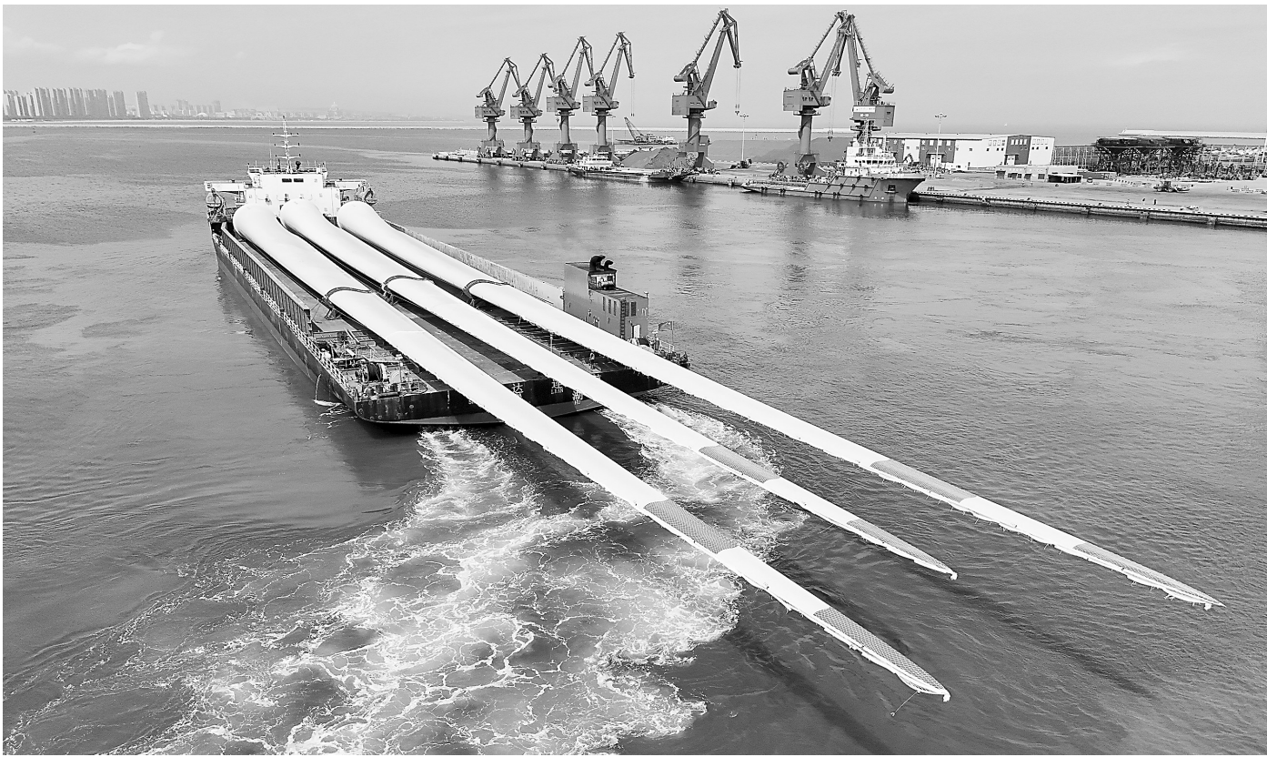
8月1日,超大尺寸海上风电叶片从山东港口烟台港蓬莱港区起运。该型叶片长达153米,重83.5吨,属于150米级超大尺寸海上风电叶片。
