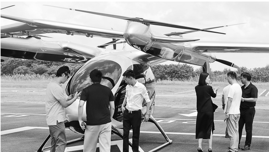
V2000CG 凯瑞鸥最大起飞重量达2吨,最大商载400公斤,巡航速度最高200公里每小时,适用航程200公里。
