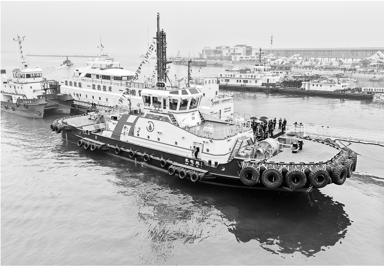
“氢电拖1”轮靠泊在山东港口青岛码头。6月26日,国内首艘氢电拖轮——“氢电拖1”轮在山东港口青岛港入列。该拖轮搭载“氢燃料电池+液冷锂电池”混动系统,可实现零碳排放。该轮投产后,预计每年可减少二氧化碳排放1500余吨。
