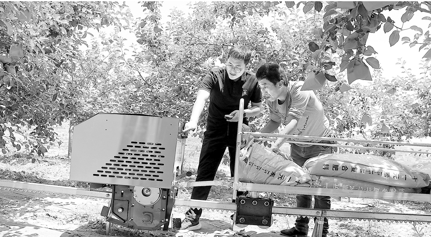
近日,在静宁县贾河乡中堡村,技术人员向农户讲解单轨运输车的操作要领。近年来,静宁县政府在部分乡镇推广这种被农户称为“山地小火车”的运输车,解决农资和果实的运输问题,有效提升劳动效率。
