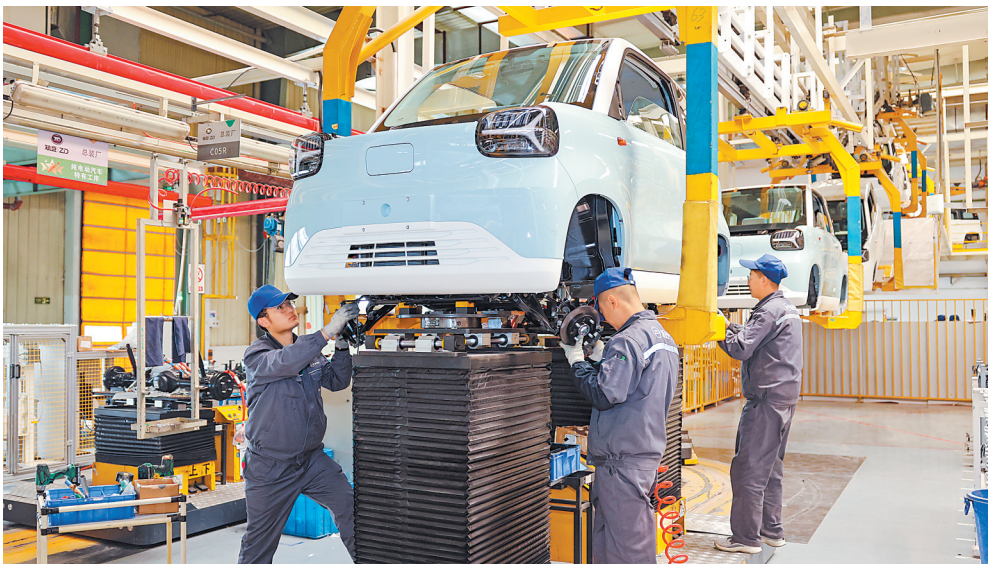
兰州新区的知豆汽车工厂整车装配车间里,工人在为车体安装悬架。
