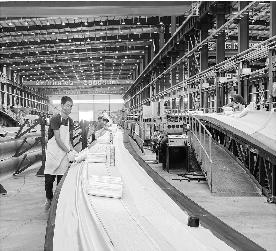
近日,位于武威市的甘肃重通成飞新材料有限公司车间里,工人正在生产线上忙碌。据了解,该公司主营业务为各型号风力发电叶片的设计、研发、制造、运维。
