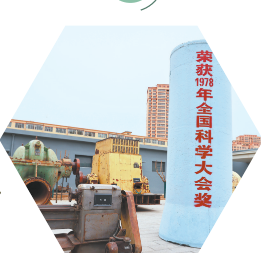
景电一期工程自行研制的预应力钢筋混凝土压力管曾经获得全国科技大会奖。 新甘肃·甘肃日报记者 高 樯
