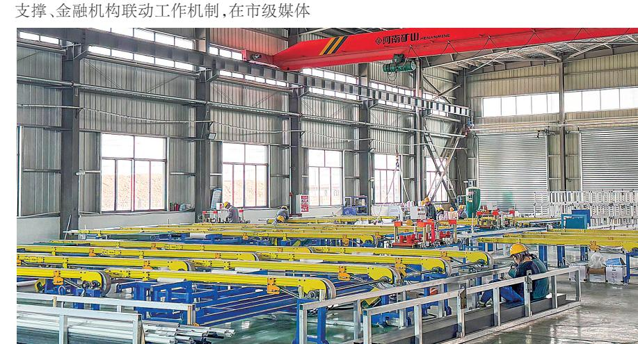
嘉峪关博丰高新材料有限公司生产线上一根根铝型材正在被调直、包装。
