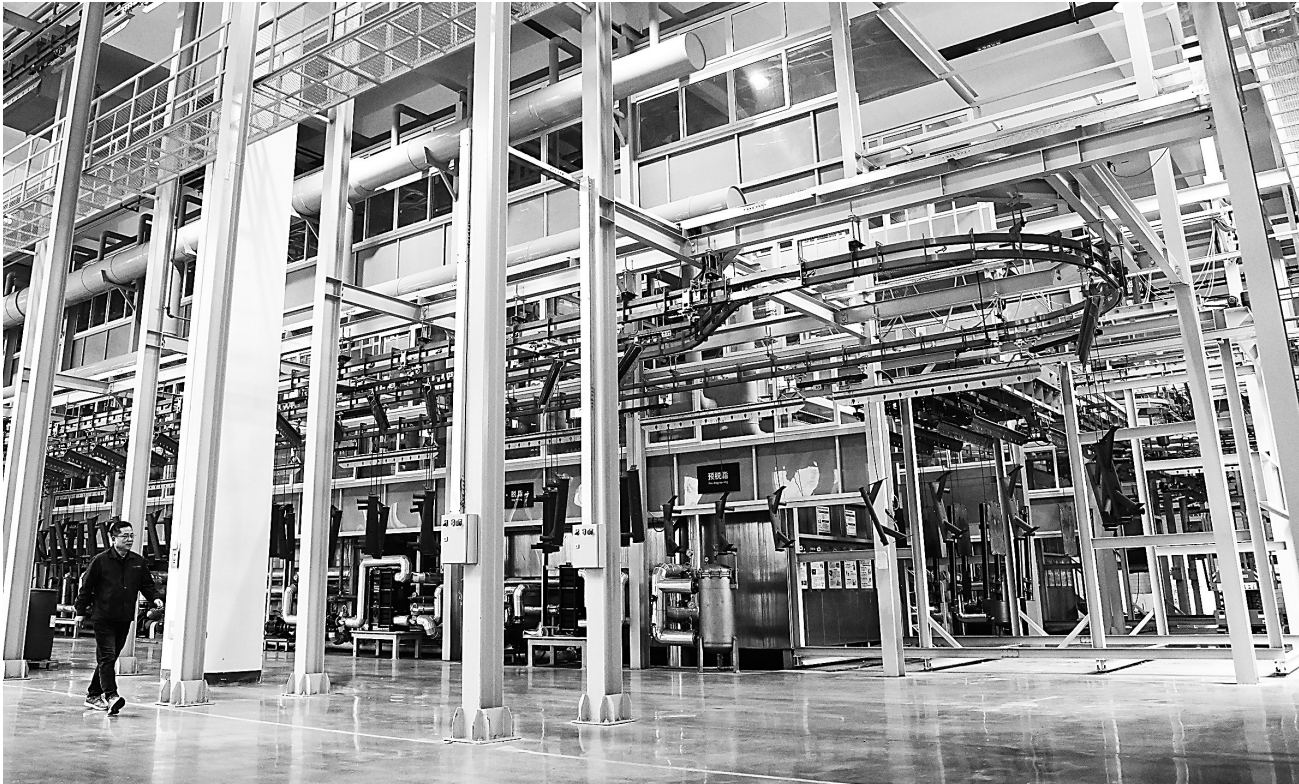
4月22日，在青岛英派斯健康科技股份有限公司智慧工厂内，自动喷涂生产线正在运行。
