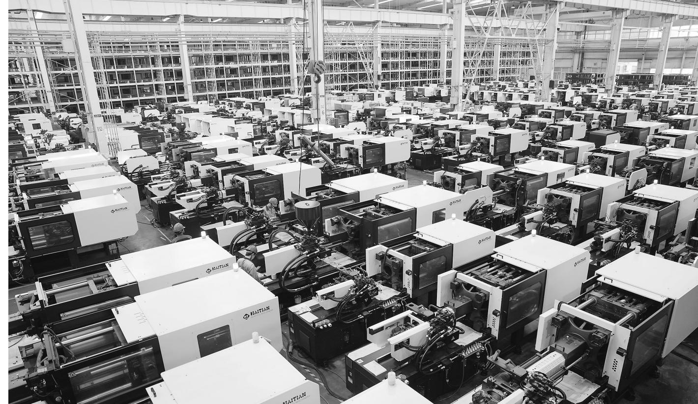
4月9日,工人在浙江省宁波市北仑区海天国际控股有限公司大港生产基地的注塑机产品整机试车调试区工作。近年来,宁波市集中精力抓好工业稳生产、促投资工作,打造一批优势产业链群。
