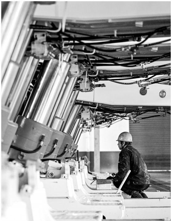
△工人在林州重机集团股份有限公司液压支架总装车间进行安装调试作业。
