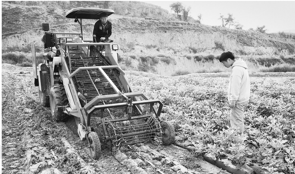
王虎存驾驶自己研发的马铃薯联合收获机进行田间试验。
