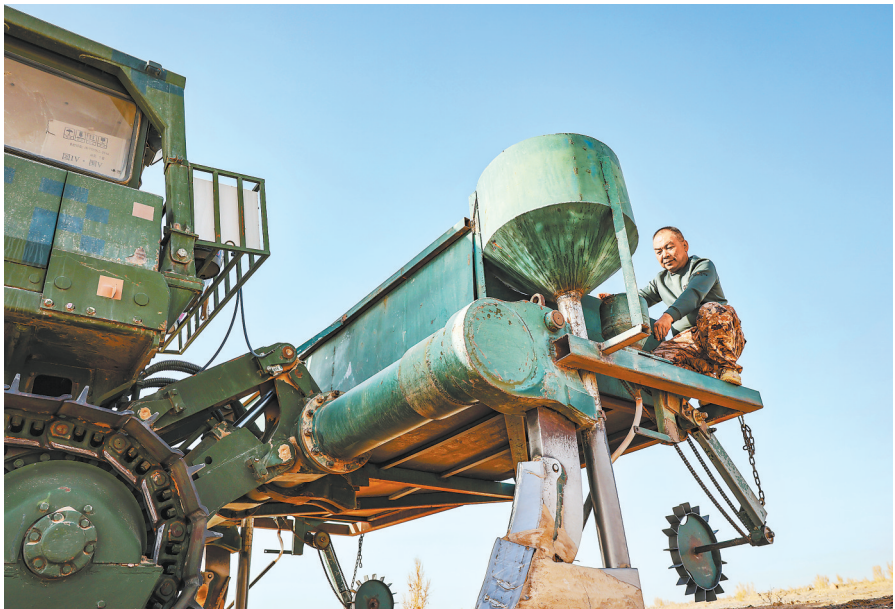
金塔县大漠农林生态产业股份公司自主研发的肉苁蓉精量播种机。
