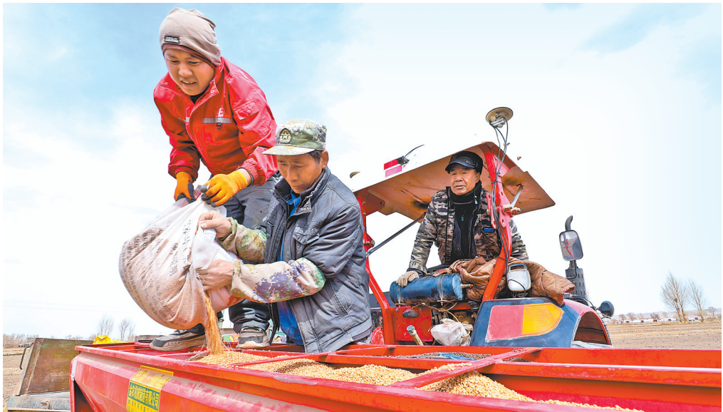
高台县宣化镇乐三村小麦种植基地,农户使用北斗导航自动驾驶拖拉机牵引的播种、施肥一体机械进行小麦播种。新甘肃·甘肃日报通讯员 王 将
