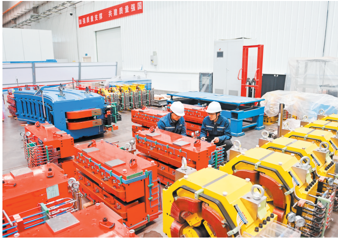
2月8日,技术人员在位于兰州新区的兰州泰基离子技术有限公司,对医用重离子加速器部件进行安装调试。 新甘肃·甘肃日报记者 丁凯
