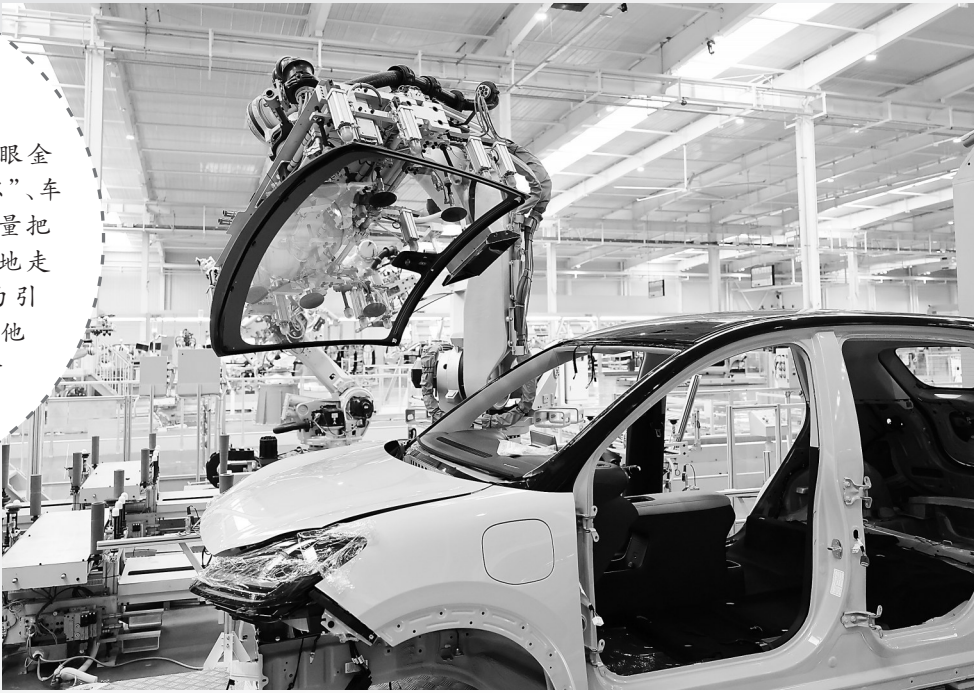
在广西柳州市一工厂,机器人为新能源汽车装配挡风玻璃。
