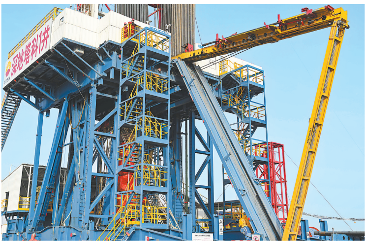
这是2月19日在新疆塔克拉玛干沙漠腹地拍摄的中国石油塔里木油田深地塔科1井局部,画面右侧为运送钻杆等设备的全自动液压猫道。本组图片均由新华社发
