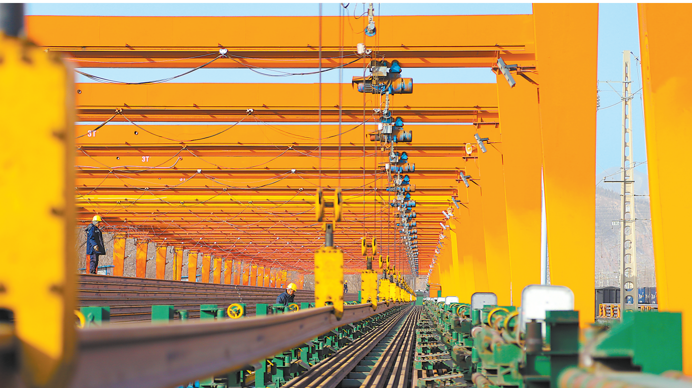
近日,在兰州河口南钢轨焊接基地内,国铁兰州局兰州工务机械段的工作人员操控机器设备加紧生产500米长无缝钢轨。据了解,这些焊接完成的钢轨将被运往新疆、青海等地。
