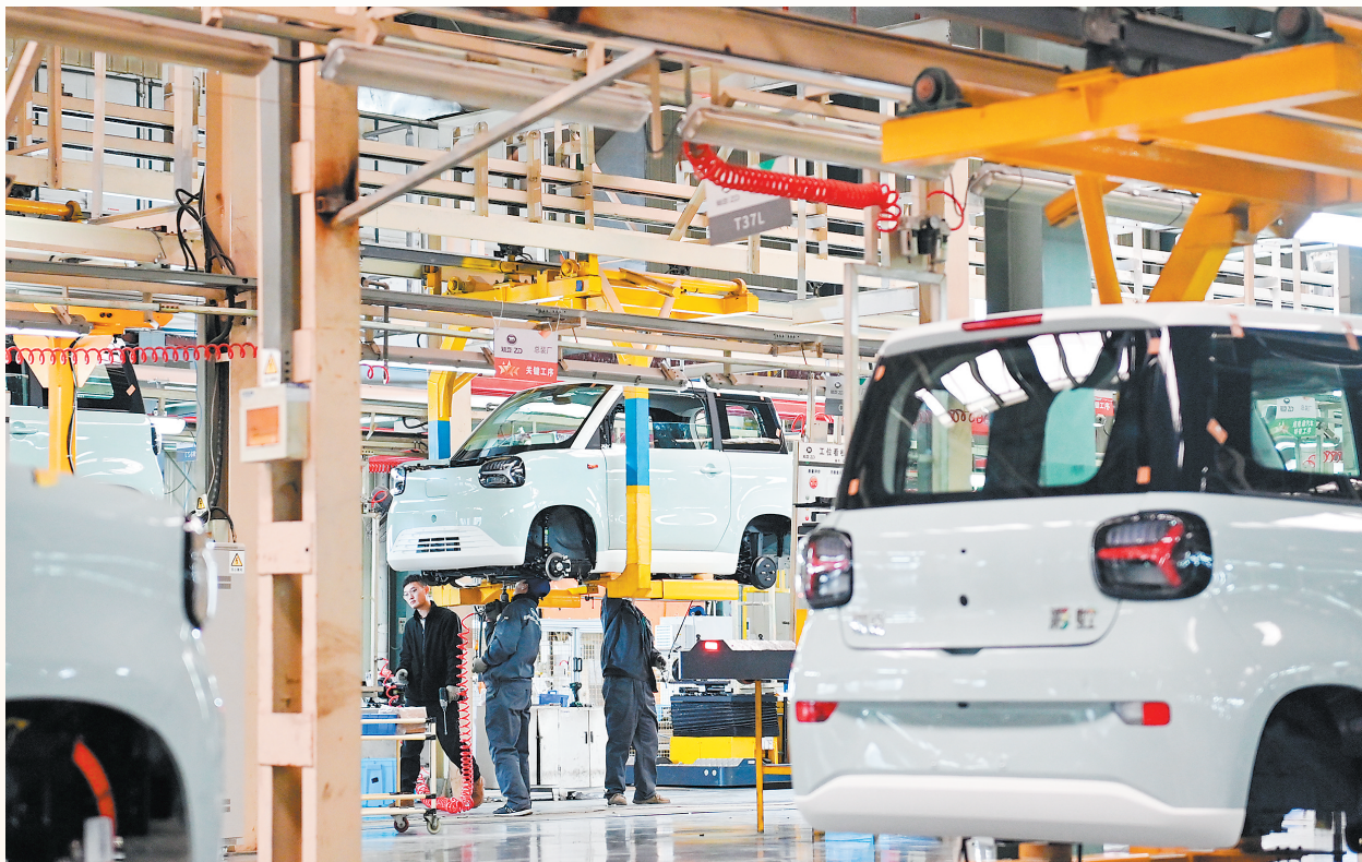
知豆兰州工厂总装车间内工人正在进行装配作业。知豆兰州工厂是西北五省区唯一一家具备新能源乘用车生产资质的工厂,拥有完整的冲压、车身、注塑、电池PACK、总装五大工艺。
