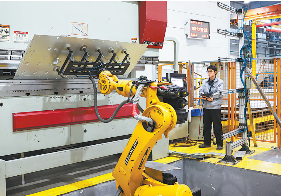
近日,天水长城控制电器有限责任公司低压成套开关柜生产线上,机械臂正在生产机柜。 新甘肃·甘肃日报记者 冯乐凯
