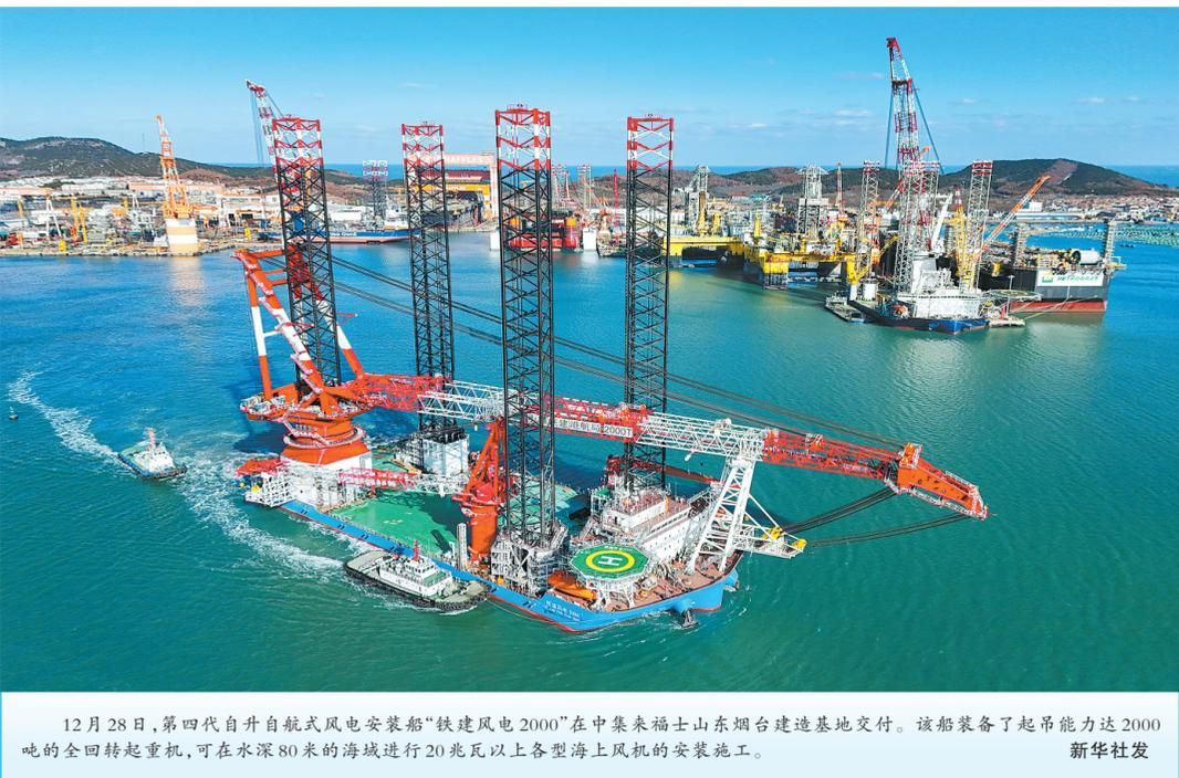
12月28日,第四代自升自航式风电安装船“铁建风电2000”在中集来福士山东烟台建造基地交付。该船装备了起吊能力达2000吨的全回转起重机,可在水深80米的海域进行20兆瓦以上各型海上风机的安装施工。
