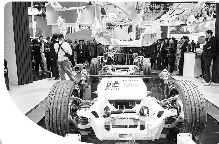
第二届中国国际供应链促进博览会智能汽车链展区展出的轻量化铝制汽车零部件。
