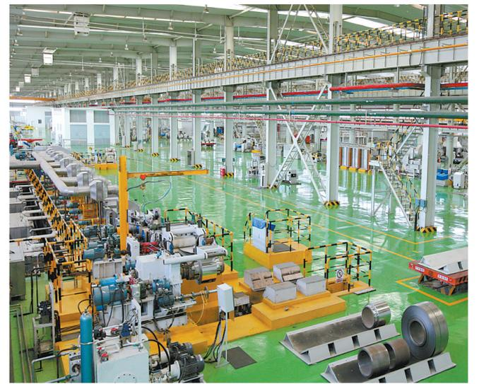
金川集团生产的0.05mm超薄“手撕镍带”广泛应用于新能源电池。图为金川集团镍合金有限公司镍带生产线。
