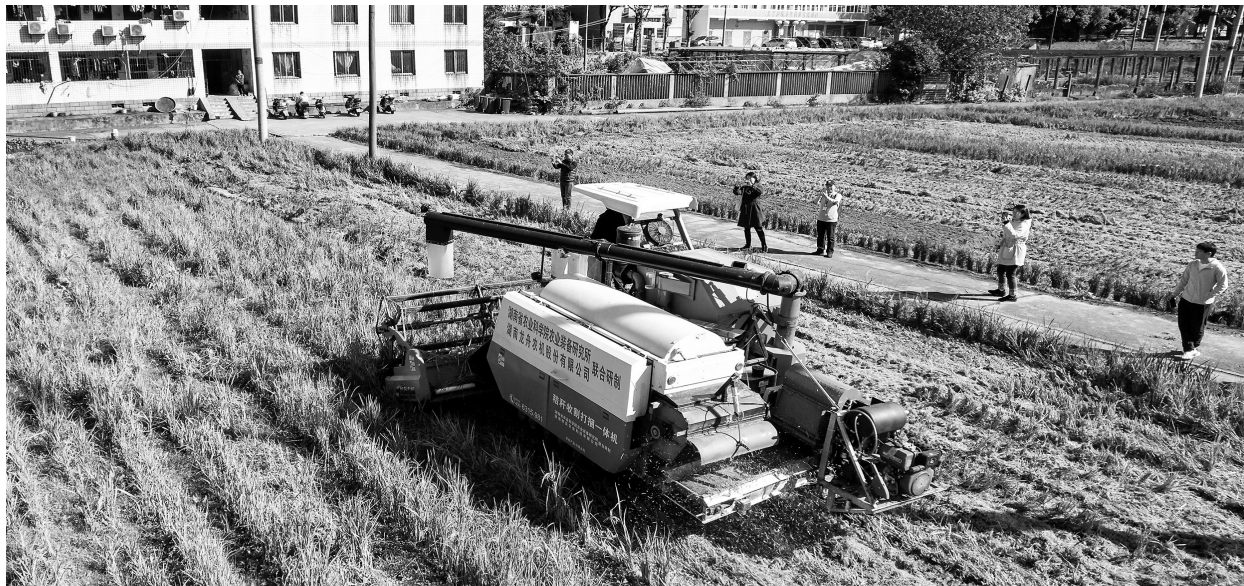
这是近日在湖南省农业装备研究所东湖路试验田拍摄的秸秆收割打捆一体机(无人机照片)。近年来，湖南发挥本省工程机械国家先进制造业集群优势，不断优化农机在农业社会化服务中的作用，加速推动湖南从传统农业向现代农业的转变。 新华社发
