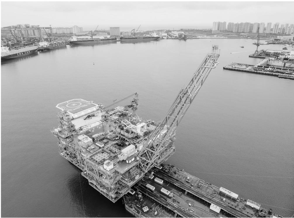
▷11月14日,全球最大变质岩油田渤中26-6油田一期开发项目中心平台在山东青岛完成吊装作业,后续将进入海上安装和联调阶段,标志着该项目陆地建造完工。新华社发
