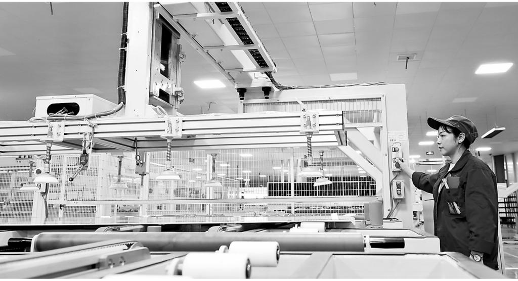
近日,工人在民乐工业园区的甘肃大民新材料800MW高效光伏组件生产线上加紧生产。新甘肃·甘肃日报通讯员 王 将
