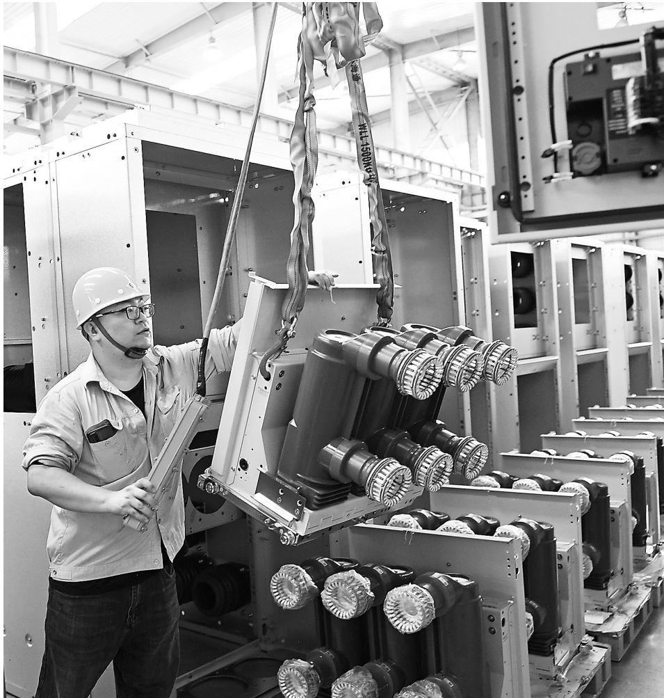
天水长城开关厂集团有限公司的工人正在装配开关柜和断路器。今年以来,该公司围绕企业转型升级,推动各类智能传感器等智能化制造技术运用。 新甘肃·甘肃日报通讯员 孙慎
