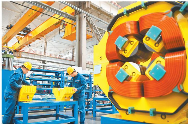
兰州科近泰基新技术有限责任公司生产车间,工人正在生产紧凑型医用全直线加速器相关部件。
